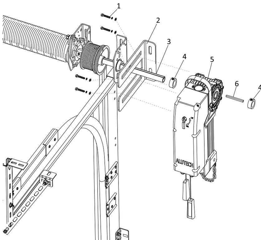
Рисунок 3. Монтаж привода на вал ворот (вертикальное положение)
