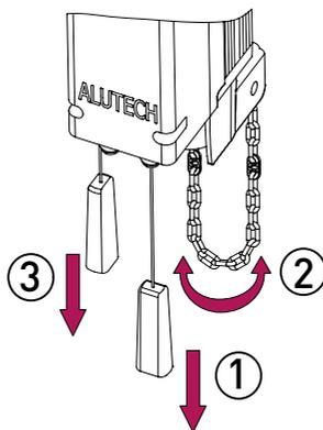
Рисунок 5. Аварийное ручное управление с помощью цепи
