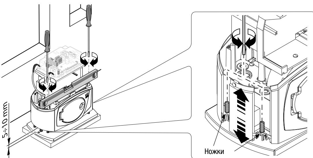
Разблокируйте привод (смотрите раздел о ручной разблокировке привода). Установите зубчатую рейку на шестерню привода.
