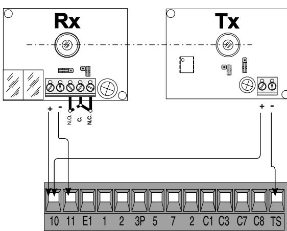
При каждой команде открывания или закрывания плата проверяет исправность и эффективность фотоэлементов. При обнаружении неисправности фотоэлементов светодиодный индикатор (PROG) на электронной плате начинает мигать: любая команда, отданная с помощью брелока-передатчика или кнопки выполниться не будет.
