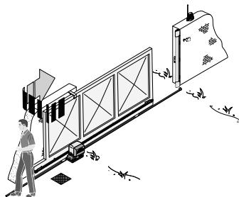
(1) Внимание: если включена функция автоматического закрывания, ворота пытаются выполнить ее три раза. Если за это время препятствие не устранено, створка останавливается в полностью открытом положении, а таймер автоматического закрывания выключается; для возобновления движения створки необходимо нажать на соответствующую кнопку брелока-передатчика или кодонаборной клавиатуры.
