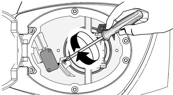
Регулировка концевого микровыключателя закрывания:
