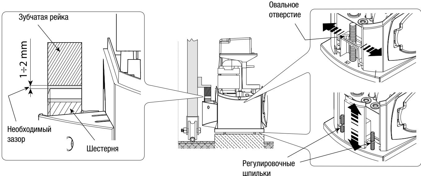
По окончании процесса регулировки зафиксируйте привод с помощью шайб и гаек.
