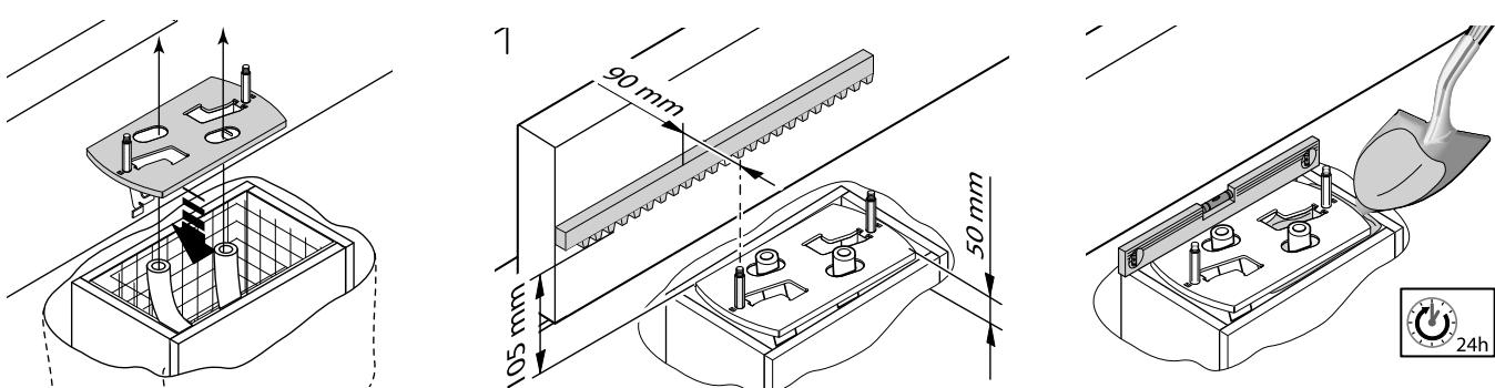
Вытащите опалубку (1), засыпьте пустое пространство вокруг цементного блока землей (2) и снимите гайки и шайбы с винтов (3). Монтажное основание должно быть чистым и абсолютно ровным, резьба винтов должна находиться целиком на поверхности. Вставьте электрические кабели в трубы таким образом, чтобы с другого конца они выходили на приблизительно 400 мм (4).
