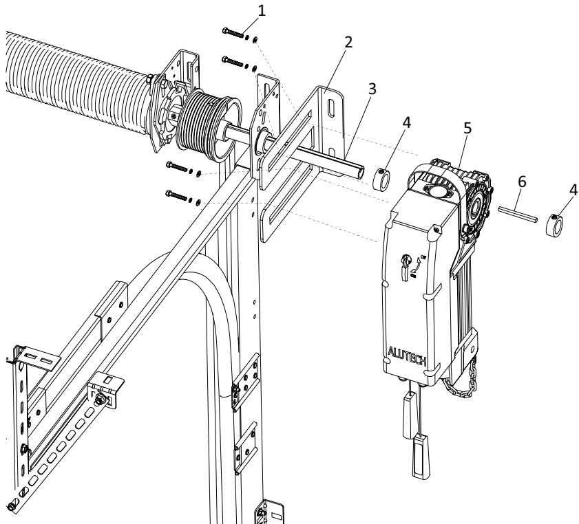
Рисунок 2. Монтаж привода на вал ворот (вертикальное положение)
