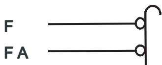
Вход для подключения концевого выключателя открытия.
