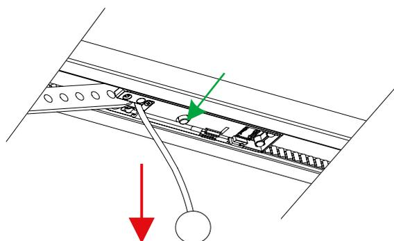
Ручная разблокировка используется в тех случаях, когда нужно открыть ворота вручную. Для разблокирования потяните вниз шнур на каретке приводной рейки. Для возвращения в заблокированное состояние нажмите кнопку на каретке, после чего переведите полотно (каретку) в зацепление.
