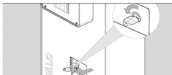
Ручная разблокировка используется в тех случаях, когда нужно поднять/опустить рейку вручную. Поверните в направлении против часовой стрелки ключ и откройте дверцу.
