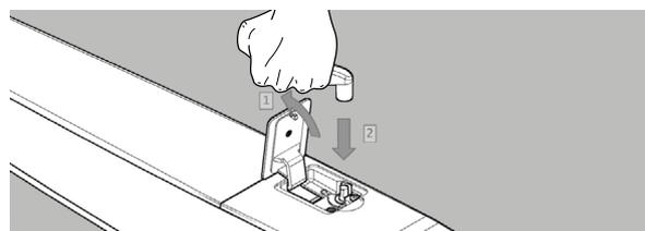
Ручная разблокировка используется в тех случаях, когда нужно открыть ворота вручную. Выполняется с помощью ключ-ручки (поворот ключ-ручки на 90°).
