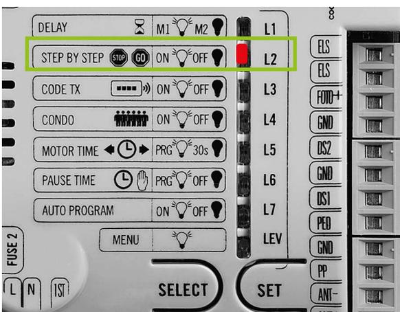
Заводская настройка (светодиод L1 не горит) — первым открывается привод подключенный к разъему **MOT1**, привод подключенный к разъему **MOT2** открывается с задержкой по времени.
