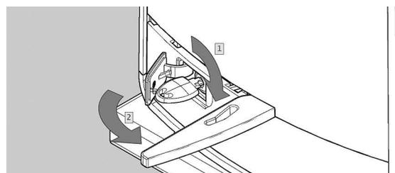
Ручная разблокировка используется в тех случаях, когда нужно открыть ворота вручную. Выполняется с помощью ключа и рычага разблокировки привода.
