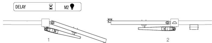
Для изменения логики (первым открывается привод подключенный к разъему **MOT2**) нажмите кнопку **SELECT** пока светодиод L1 не начнет моргать. Затем нажмите кнопку **SET** — светодиод L1 загорается и горит постоянно.
