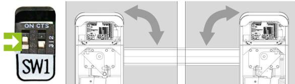
DIP-переключатель №1 **SW1**, позволяет изменять направление движения рейки, без изменения электрических соединений. После подключения к сети, первая управляющая команда (например, с пульта радиуправления) должна выполнять открытие. Если условие не выполняется, установите переключатель №1 **SW1** в другое положение.
