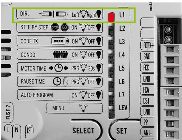
Заводская настройка — привод установлен справа (при входе в главное меню настроек светодиод L1 не горит).
