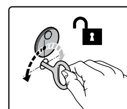
• **Ручная разблокировка мотор-редуктора** (в соответствии с приобретенной моделью)
